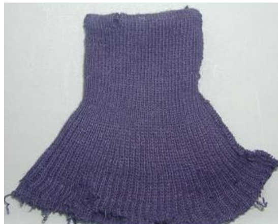
Σχήμα 5. Λάσιχο RIB – Μανικιού, «Διπλωμένη» μορφή (όπως είναι γαζωμένο στο μανίκι).
