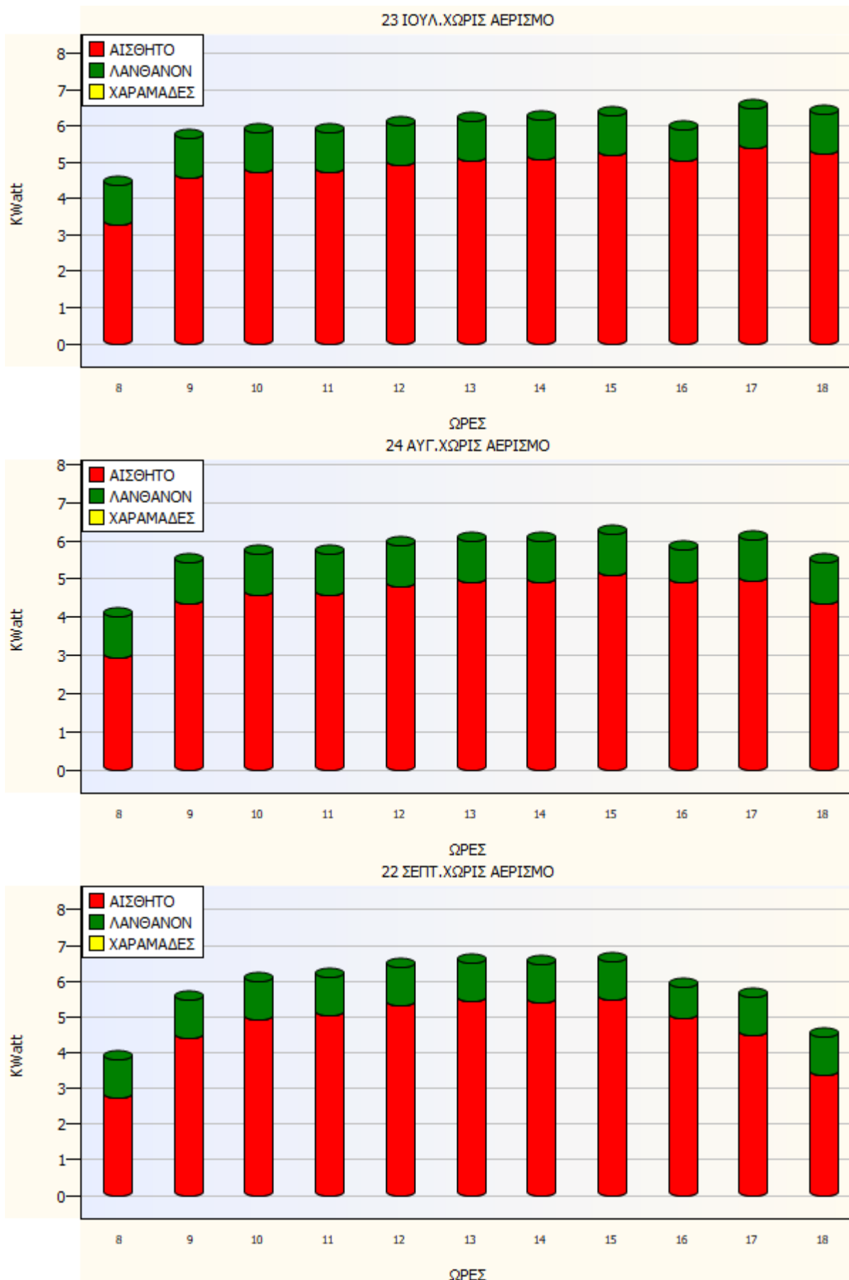
Διαγράμματα Συγκεντρωτικών Φορτίων Κτιρίου Με Αερισμό
